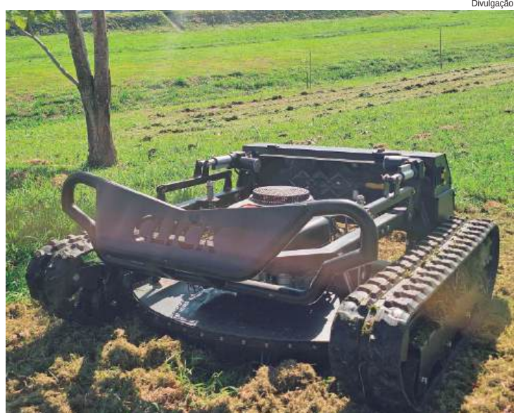
Cortador de grama conta com controle remoto, esteiras e capacidade para operar em terrenos com inclinação de até 70 graus
