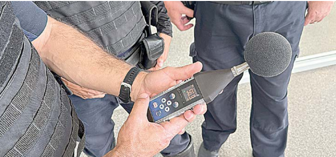
O sonômetro é o aparelho utilizado para medir o nível de pressão sonora em determinado ambiente
