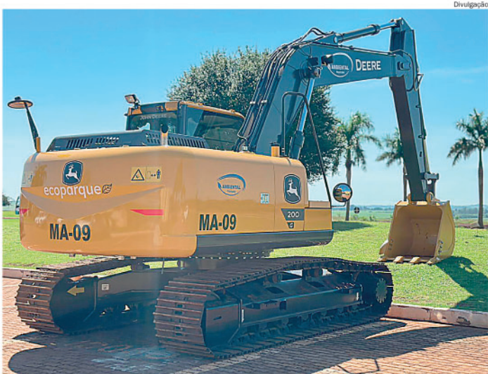
Escavadeira hidráulica possui capacidade de 20 toneladas
