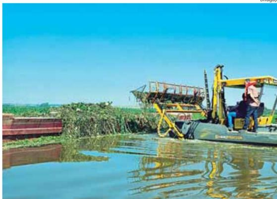
Trator aquático recolhe carga e coloca em embarcação de areia
