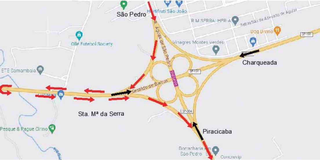
Restrição de tráfego no local será necessária para execução de trabalhos de alargamento do dispositivo na SP 304
