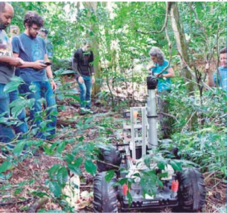
Teste do protótipo de robô terrestre para coleta de amostras à distância em uma floresta em Piracicaba
